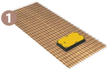
1 Positionieren des RÉZABOITE SCHAL-BETONPLATTE durch das Fertigteilwerk.
