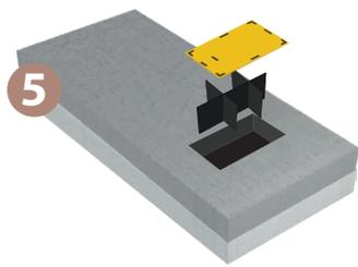
5 Ausschalen der Abdeckung und der Verstärkungen des RÉZABOITE SCHAL-BETONPLATTE.
