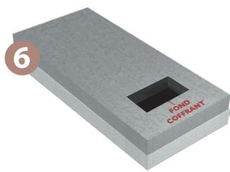
6 Der Schalungsboden wird für einen sicheren Halt seitlich im Beton verankert.
