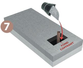
7 Ausschneiden des Schalungsbodens mit einer Lochsäge / Säbelsäge auf den Durchmesser der zukünftigen Durchführung. Durchführen der Leitung / des Schachts durch die geschaffene Öffnung.
