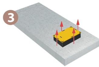
3 Lieferung und Entfaltung des RÉZABOITE SCHAL-BETONPLATTE durch den Verschaler.
